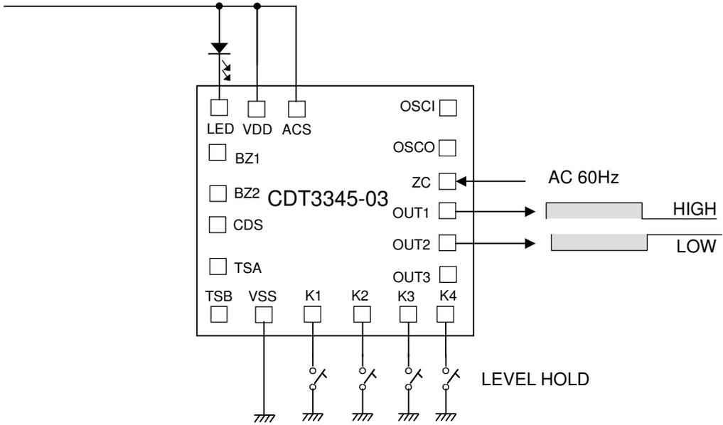
(d). 使用 AC 60Hz , 固定時間 (ASC = 1) : 4PIN 接法
